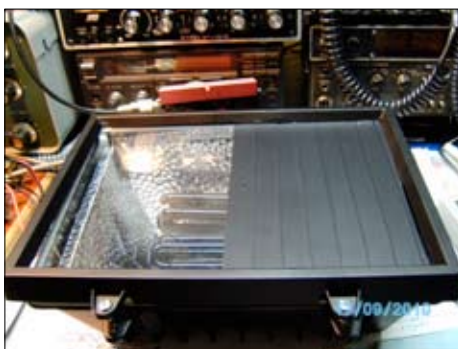
Bild 2, skyddsglaslet delvis maskat så att ljusgenomsläppet ungefär motsvarar europakortformat.
