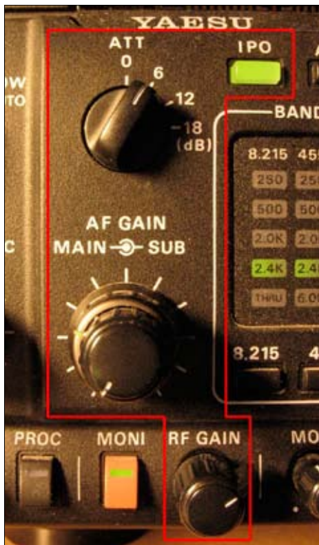
Bild 1: Fyra reglage för att optimera mottagarens känslighet: Pre-Amp av/på, dämpare, AF-gain och RF-gain. Foto: SM5AJV
