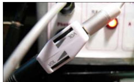
Bild 2. Ett enkelt sätt att minska känsligheten i hörlurarna är att koppla in en variabel dämpning. Ovanstående lilla dämpare finns att köpa på Clas Ohlson. På köpet får man ett extra uttag som kan användas för t.ex. inspelning. Foto SM5AJV
