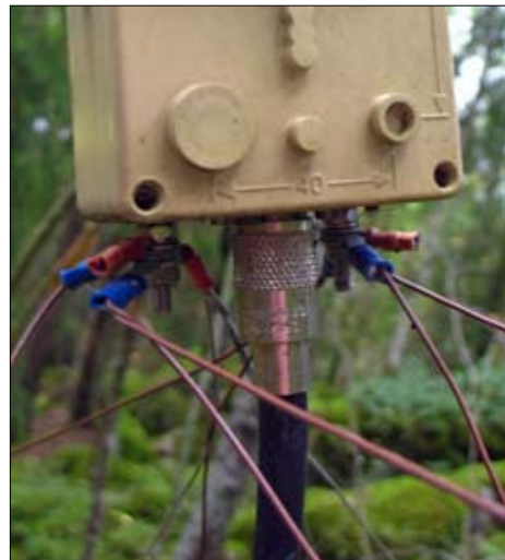
Ett mindre bra radialsystem hos SM5AJV! För få och för tunna trådar. Foto: SM5AJV
