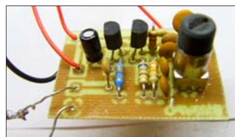
Bild 4, Prototyp HF VCO för 5,5MHz.
