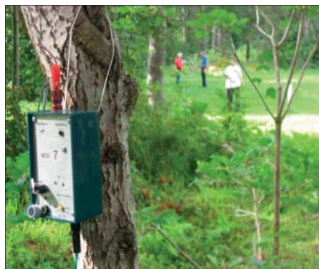
De små mikro-sändarna för 3,5 MHz som användes. Sändarna sattes ut dagen före tävlingsstart och gick igång exakt 24 timmar efter att de startats. Foto: SM5SVM
