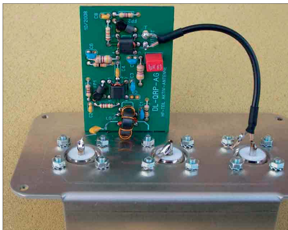
Den lilla Norton-förstärkaren på sitt kort. PL-kontakten i mitten till feederkabeln. Loopen anslutes till kontaktarna till vänster och höger.
