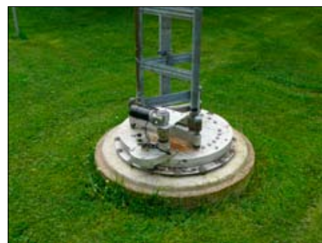
Så här ser det ut i botten av masten. Ordentlig lagring och enkel drivning. Det är faktiskt resterna av en Bofors-kanon från 1940... Foto: SM4DHN
