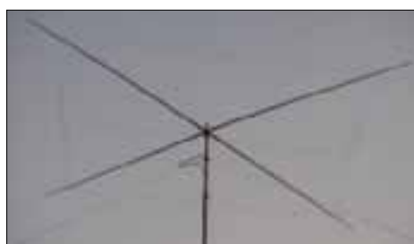
Fig 13, 21 MHz antennen med spridare av 4 m metspön från Biltema.
