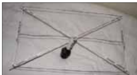
Fig 12, 144 MHz antennen med spridare gjorda av blompinnar och stagröret av 40 mm PP-rör.
