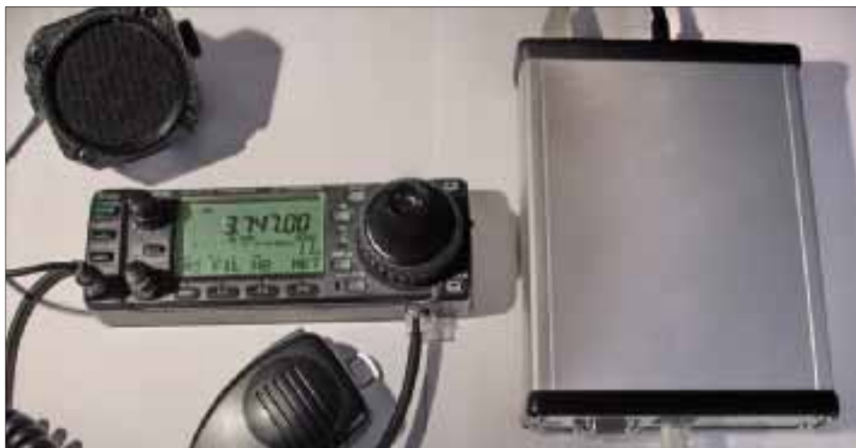
Lätt packning. Panel till IC-706 kopplad till mikrofon, högtalare och kommunicerande via RRC-1258. Mikrofon, högtalare och telegrafnyckel anslutes. Spänningsmatning till och anslutning till bredband så är man körklar. Foto: SM0JZT.
