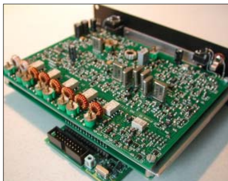
Fig 3, A-kortet. Detta kort innehåller i huvudsak mottagare-kedjan, mikrofonförstärkare, talkompressor och bandpassfilter.
