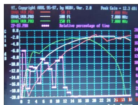
Fig 11, 40-metersantenn på 15, 30 och 45 meter: Den högsta antennen går bättre under 15 grader och sämre över 19 grader.
