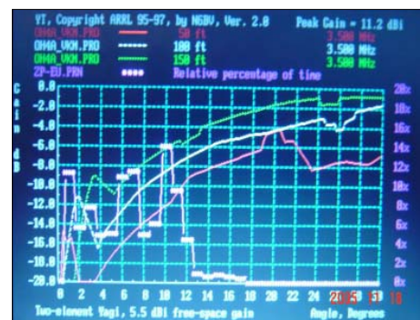
Fig 12, 80-metersantenn på 15, 30 och 45 meter: minst 2 dB förstärkning för en höjning på 15 m.
