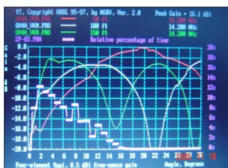
Fig 9, vertikalt strålningsdiagram för en 20-metersantenn på 15, 30 och 45 meters höjd och sannolikheten för signalens infallsvinkel:
