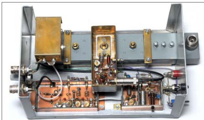
Den ”nya” 6 cm konvertern! Oscillator med buffertsteg längst ner till höger och LO multiplikatorn till vänster. Överst vågledarsektionen med MF förstärkare och filter. I den nedersta BNC-kontakten kan LO frekvensen på 468 mätas och i den övre går 144 MHz-signalen ut. Foto: SM6JIX, Lennart Benson
