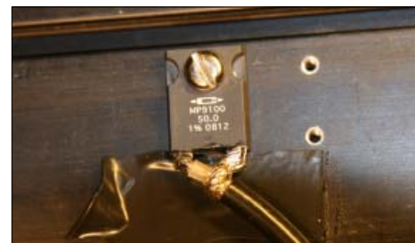
Bild 6, Caddock-motstånd monterat på kylfläns.
