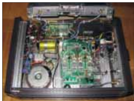
Fyrens insida. Överst i bilden syns frekvensgeneratoren. Under det drivsteget för 13 cm. Steget i mitten är uppdelat i tre delar, drivsteg och slutsteg för 23 cm samt slutsteg för 13 cm. Till vänster återfinns nät-del, temperaturvakt samt nycklingslogik.
