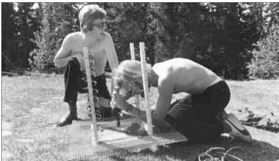
Klåddergårde 1974! SM6FHZ tittar på medan jag borrar fastsättningshål för N-kontakten till quad-helixen.
