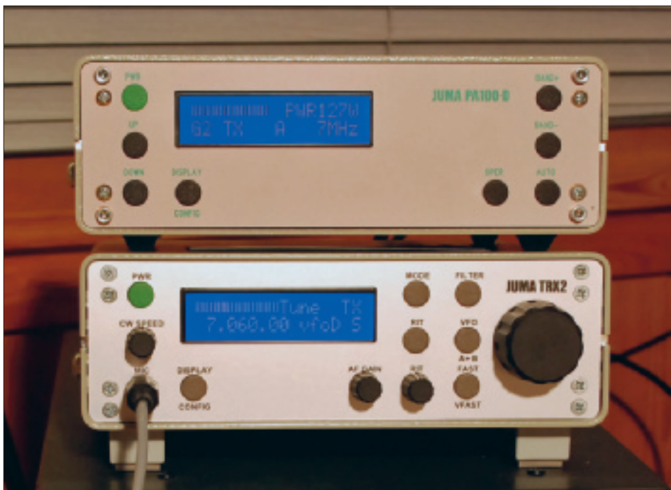
JUMA TRX-2 har blivit med PA. På bilden ser man digitalversionen som automatisk byter band och visar alla mätvärden på en digital display. Vackert bygge som kan anslutas till alla QRP-riggar med uteffekt mellan 3 och 10 watt. Foto OH2NLT
