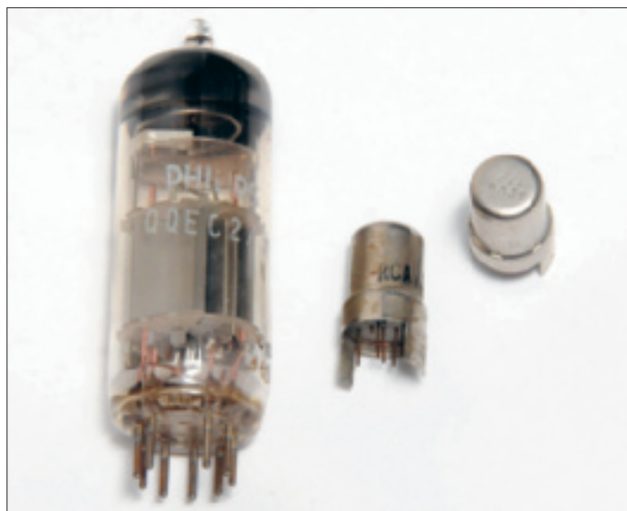
Detta är det QOE02/5 som satt i den 70 cm tripplare som jag körde DL9AR med! Nuvistorerna på bilden satt i min ELFA-konverter för 2 meter. En 6CW4 gav ca 3-4 dB NF på 2 meter.
