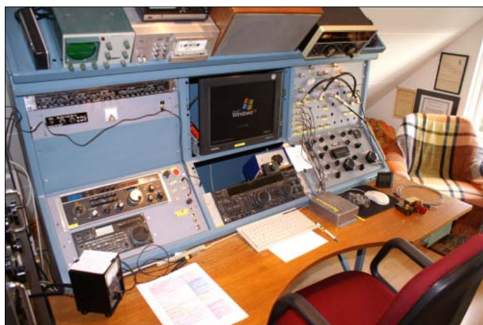
Running station under SAC CW 2008. FT-100MP, hembbyggda och kommersiella slutsteg, loggprogram N1MM. Separata lyssningsantennerna (Beverage och K9AY-loop).
