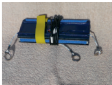
Den färdiga solcellspanelen väger 200 g, inklusive kabeln, och dess mått är 257 x 155 mm (155 x 65 x 25 mm ihopvikt).
