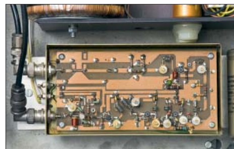
Sändarstrippen från 54 till 432 MHz. Osc. Kommer in längst ner till vänster och förstärks först i ett buffertsteg. Därefter 3 st dubblare längst ner. Upp till höger ett förstärkarsteg. Sedan går signalen mot vänster in i en dämpsats och sedan ut till PA modulen. Foto: SM6JJX Lennart Benson.
