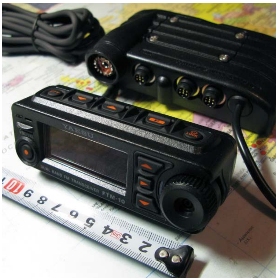
Fronten känner vi igen från FTM-10E. Där bakom ligger den lilla "huvudenheten". Uteffekten är sänkt och monterbarheten även i mera krävande omgivning är möjlig.
