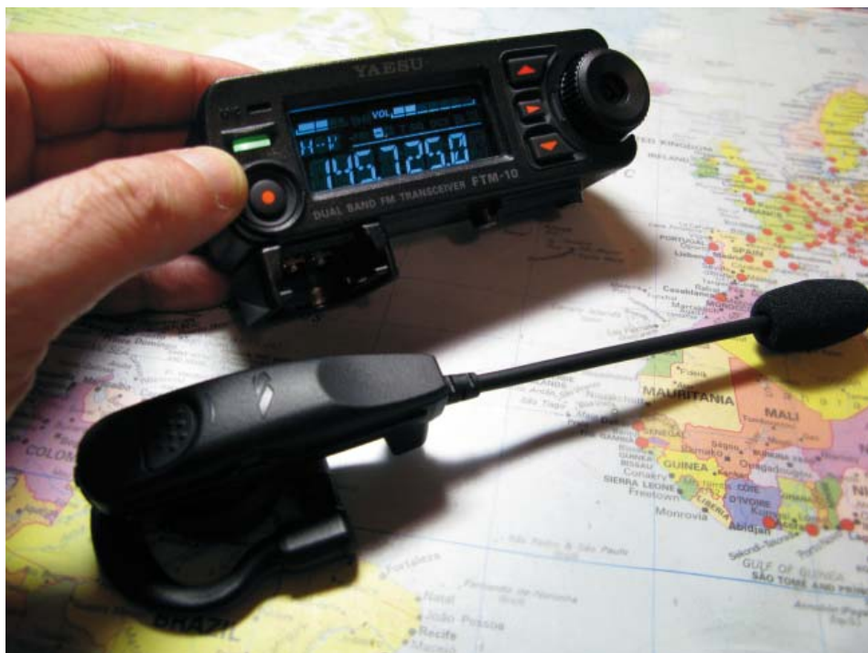
Ovanför tummen sitter den i fronten inbyggda mikrofonen. På bilden syns även blåtandsheadsetet BH-1 från YAESU. På frontpanelens underkant ser man den tillbehörs CAB-1 som möjliggör laddning av headsetets batteri.
