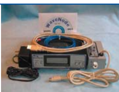
Wavenode SWR/PWR analys Mät swr, pwr, spektrum mm Upp till 4st olika sensorer
