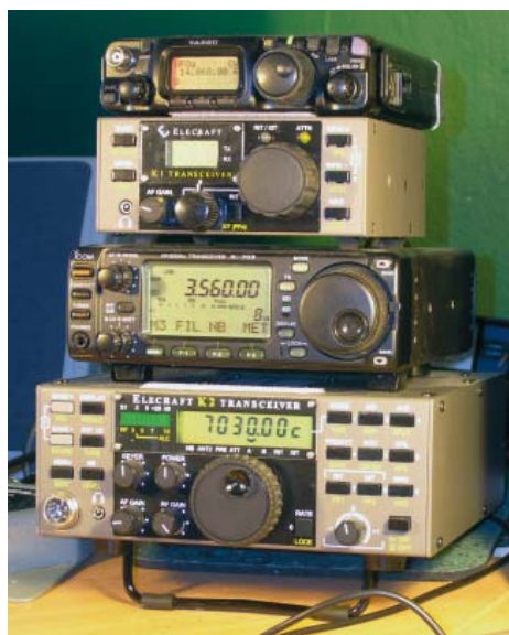
Det finns många riggar att välja på för dig som vill köra QRP. Överst en Yaesu FT-817, följt av Elecraft K1, ICOM IC-703 och Elecraft K2.
