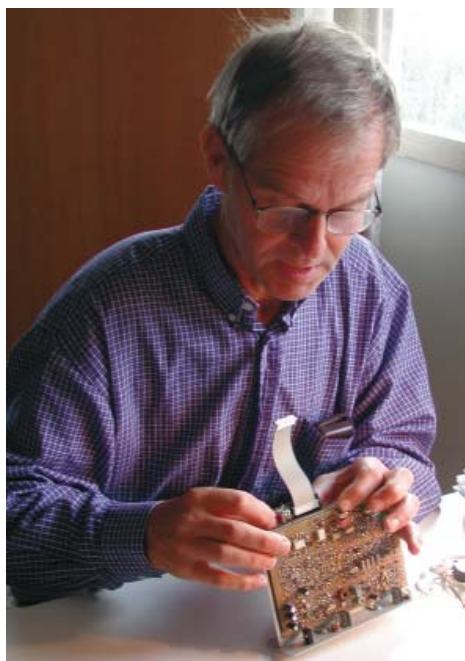
Trollkarlen Olle SM6DJH från Kungshamn sätter här samman prototypen, i slutet på september 2007. A- och B-kortet sitter skruvade på var sin sida om en kylplåt, som i sin tur sitter skruvad till bakpanelen med alla kontakter.
