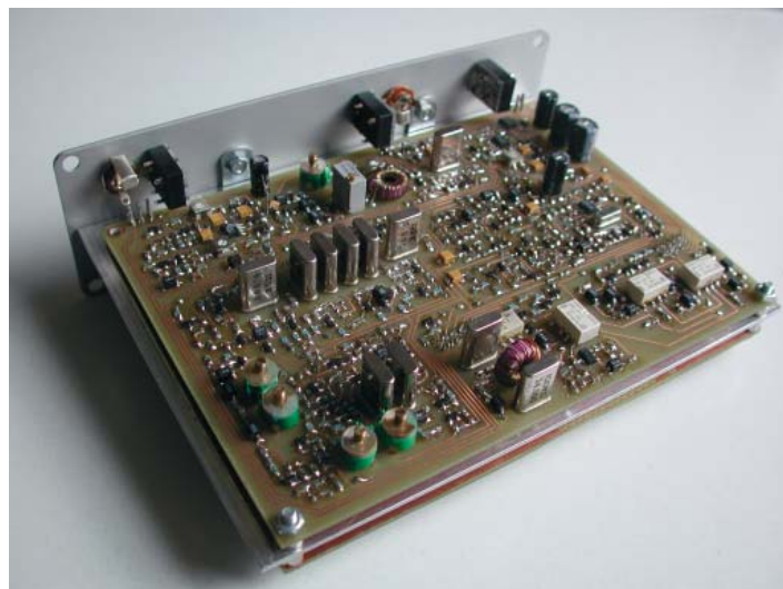
Till vänster A-kortet med drivsteg, slutsteg och bandpassfilter. Här finns även tre uppsättningar filter för rening av signalen från DDS:en. Till höger B-kortet med hela mottagare och sändare-kedjan. Längst fram i mitten ser man det flotta filtret för första MF:en på 24MHz. Till vänster därom två kristaller för sidbandsoscillatorerna.
