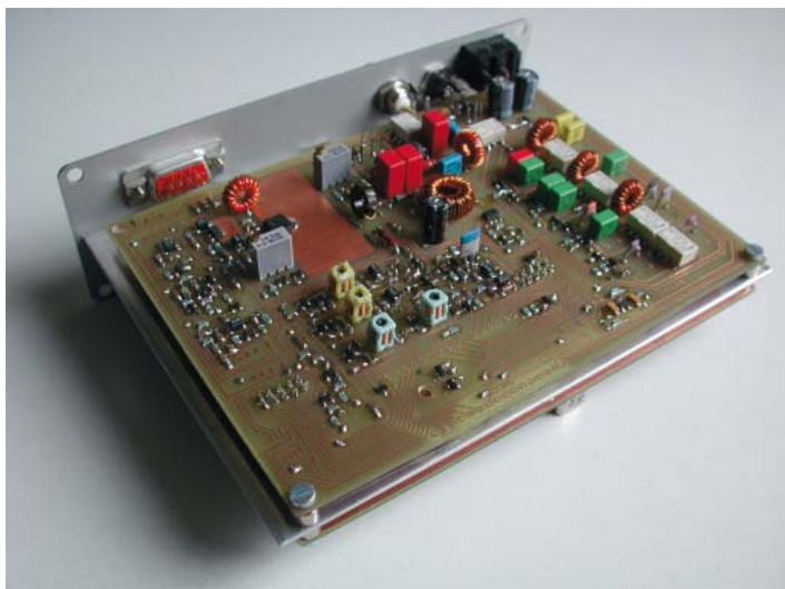
Till vänster A-kortet med drivsteg, slutsteg och bandpassfilter. Här finns även tre uppsättningar filter för rening av signalen från DDS:en. Till höger B-kortet med hela mottagare och sändare-kedjan. Längst fram i mitten ser man det flotta filtret för första MF:en på 24MHz. Till vänster därom två kristaller för sidbandsoscillatorerna.
