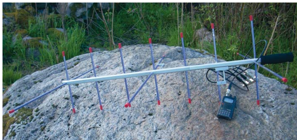
Handburen utrustning för satellittrafik, en två-bands transceiver och två-bands Yagi.
