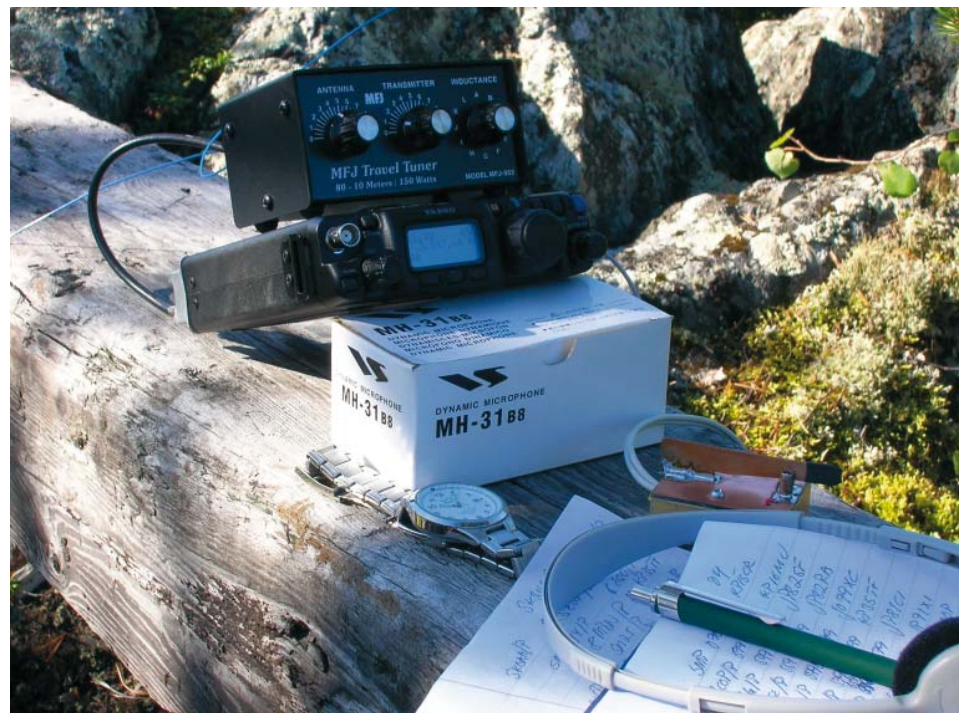
Riggen, en FT-817ND, MFJ Travel Tuner och en hembyggd liten manipulator till riggens inbyggda elbugg.
