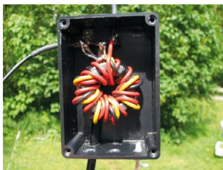
Fig 2, Den trifilärlindade transformatorn med kärna typ FT-140-77.
