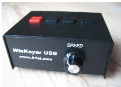
WinKeyer USB med hastighetskontroll på framsidan och fyra tryck-knappar på ovasidan. Foto SM5AJV.
