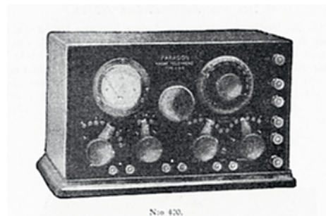
Bild 3, amatörsändare för telegrafi eller telefoni.
