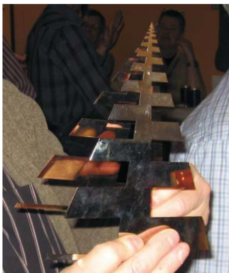
Den logperiodiska mataren som har ca 200 Ohm balanserad matningsimpedans.
