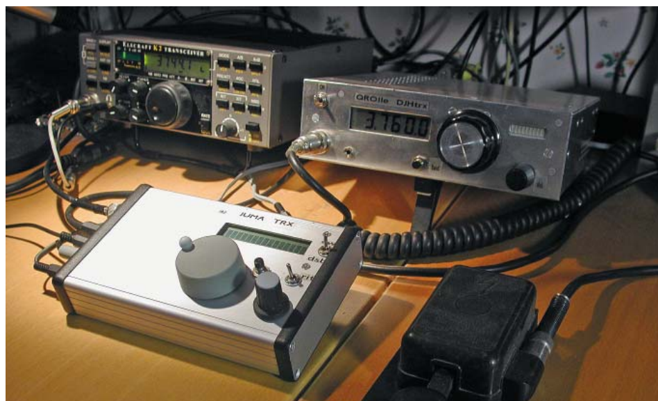
JUMA-TRX1 är en spännande liten QRP-rigg från våra vänner i OH-land. Här ses undertecknads rigg som lätt modifierad gör sällskap med en Elecraft K2 och en QROlle. Alltså i gott sällskap. Handpumpen nere till höger gör god tjänst vid CW-körande när man inte kör DSB.
