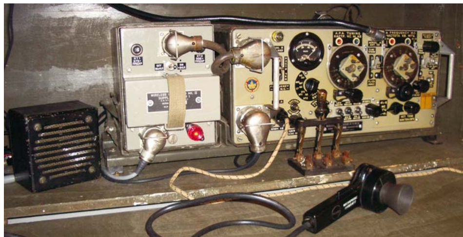
Tranceöver typ Wireless SET No. 19 monterad i transportlåda. Mikrofonen är original från 1942 och av Moving Coil typ. Sändaren täcker 2-8 MHz och lämnar 13 watt CW och 3 watt AM. (Ägare SM7EQL, Bengt)
