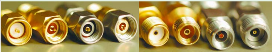
SMA-kontakten och dess avarter. Från vänster, SMA, 3,5 mm, 2,92 mm och 2,4 mm. Foto: SM6YAT Erik.
