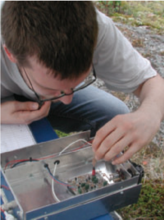
När en VFO behöver trimmas i fält får en "skogspinne" duga som icke magnetisk trimmejssel. SMOYSR flyttar den egenbyggda VFO:n till 80meter CW-del.
