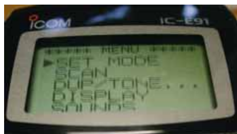
LCDisplay av "punktmatrixtyp" ger mycket god flexibilitet och användbarhet. Även bakgrundsbelyst och omställbar kontrast.
