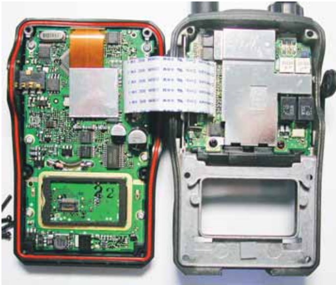
Under skalet kan vi radioamatörer inte göra särskilt mycket nytta bland alla ytmonterade komponenter. Digitaldel till vänster med plats för UT121, analogdel till höger.
