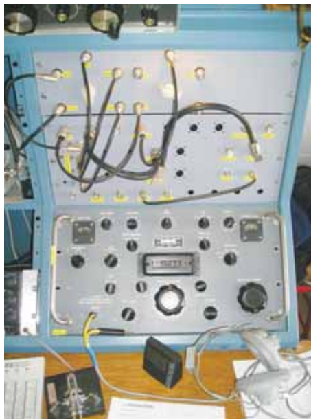
Extra lyssnings-RX med tillhörande in- och utgångar för RX-antennor och in- och utgångar för TX samt slutsteg.
