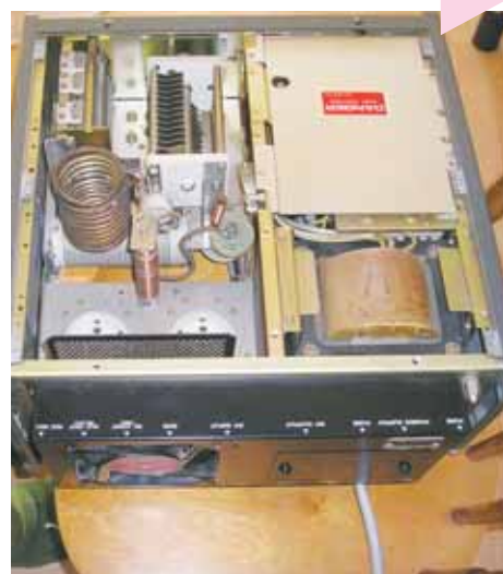
Koll av slutsteg innan tävlingen. TL 922 gjorde ett bra jobb, knappt varmt efter 48 timmars körning.
