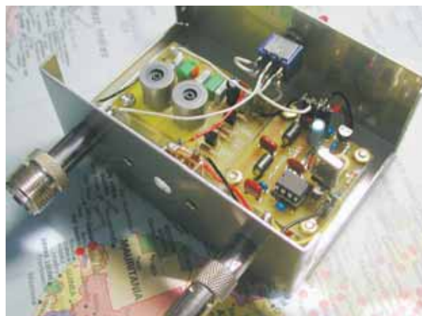
En liten låda för långa vågor. Till höger en konverter och till vänster en förstärkare och preselektoroptio. Bygg denna och kom igång med lyssning på riktigt långa vågor.
