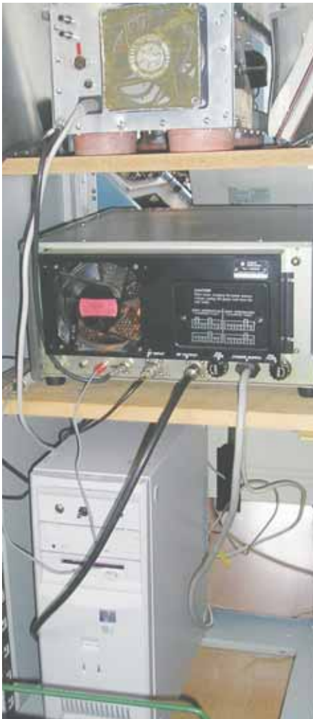
Baksidan av racket som innehåller baksida på två slutsteg och dator för loggning.
