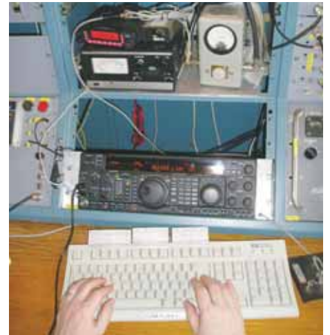
Stationsplatsen med tillhörande transceiver, clusterradio, effektmeter och keyboard för dator.
