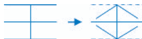
Själva grundtanken med antennen är att ha vikt reflektor och direktor. Därmed kan man bygga den med sträckt tråd.
