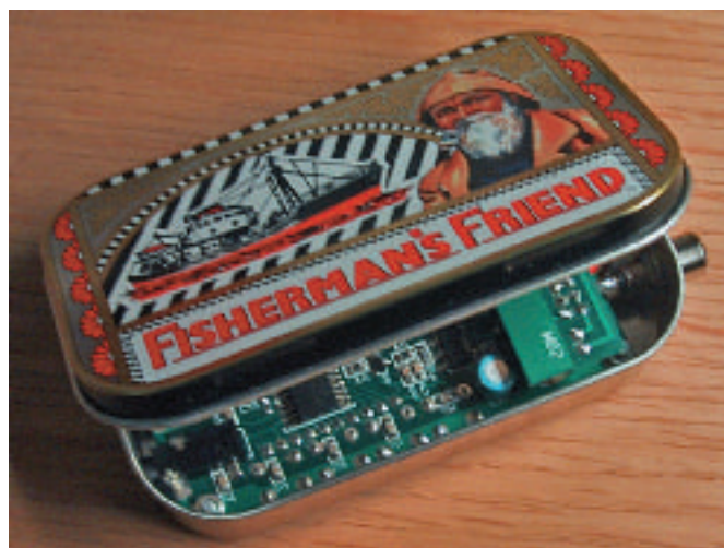
Under locket på asken (riggens baksida) kan man se riggens kretskort med sina ytmonterade komponenter.
